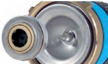
▲ Bild 4 • Der „BlueOne“-Motor ist als 12-poliger, elektronisch kommutierter Synchronläufer (EC-Motor) ausgelegt, der einen 14-poligen Permanentmagneten im Innern des halbkugelförmigen Rotors antreibt. Seidenweicher Motorlauf und fast geräuschloser Pumpenbetrieb ohne hydraulische Leistungseinschränkungen sind das Ergebnis.
