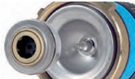
▲ Bild 4 • Der „BlueOne“-Motor ist als 12-poliger, elektronisch kommutierter Synchronläufer (EC-Motor) ausgelegt, der einen 14-poligen Permanentmagneten im Innern des halbkugelförmigen Rotors antreibt. Seidenweicher Motorlauf und fast geräuschloser Pumpenbetrieb ohne hydraulische Leistungseinschränkungen sind das Ergebnis.
