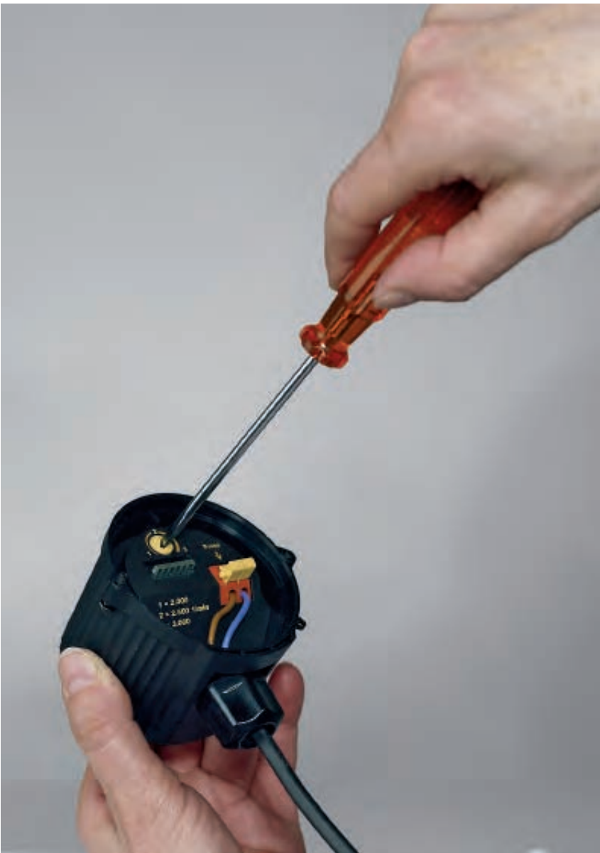
◀ Bild 6 • Je nach Leistungsanforderung (z.B. bei kleineren Rohrnetzen) kann die Pumpendrehzahl flexibel von 3.000 1/min auf 2.000 1/min reduziert werden. Geringerer Stromverbrauch ist die Folge.
